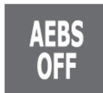
La spia si accende quando AEBS è disattivato e quando il sistema ESP viene disattivato premendo l'interruttore ESP OFF.
