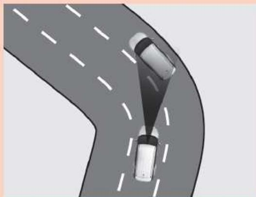
Durante una guida in curva, l'AEBS può riconoscere un veicolo in un'altra corsia come un veicolo che precede e attivare avvisi e forza frenante inutili. Stare sempre attenti al traffico e ridurre la velocità del veicolo premendo il pedale del freno, se necessario.
