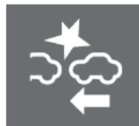
La disattivazione del sistema farà sì che la spia AEBS sul cruscotto si illumini. Lo stato ON/OFF del sistema può essere visualizzato nel menu Impostazione utente sul cruscotto. Se l'indicatore è illuminato continuamente con AEBS abilitato, far controllare il veicolo presso un Concessionario Ssangyong o un centro di assistenza Ssangyong autorizzato.
